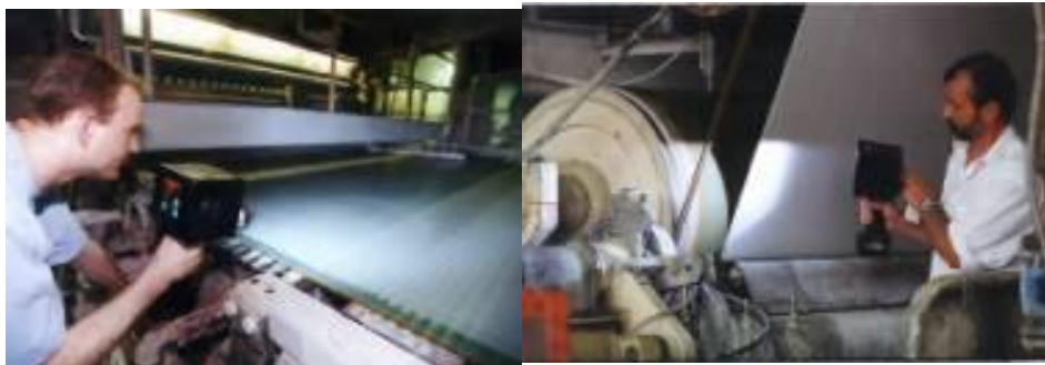
Contrôle des pièces en mouvement en utilisant un stroboscope
