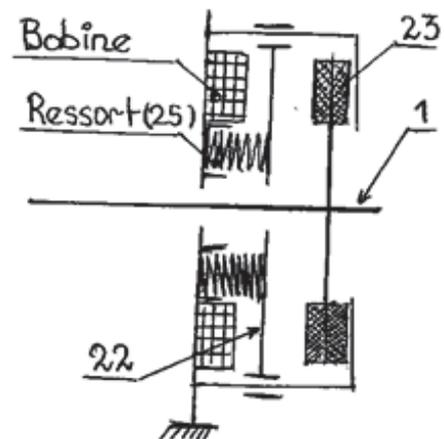
3.) Déterminer l'effort de freinage pour un couple de freinage  $C_f = 35 \text{ N.m}$ .
