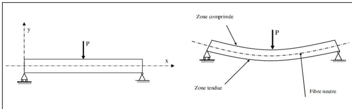
Figure 6.2: Modélisation d'un essai de flexion trois points.
