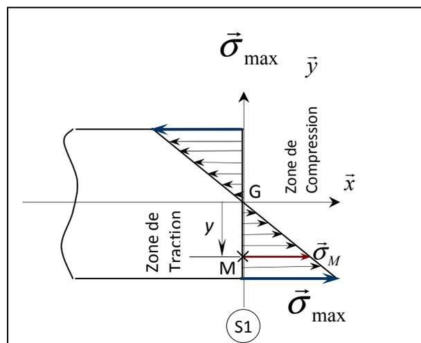
Figure 6.4: Répartition des contraintes dans une section droite.
